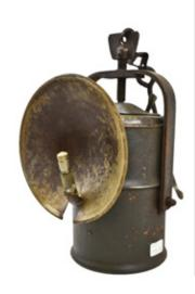
Die Lampe besteht aus zwei Behältern. Der obere ist mit Wasser gefüllt, der untere mit dem Calciumcarbid. Tropft nun Wasser von oben auf den Brennstoff, entsteht das Gas Ethin, das über eine kurze Rohrleitung in den Brenner aufsteigt, wo die Flamme entsteht. Hinter der Flamme befindet sich ein metallener Hohlspiegel, der das Licht bündelt und vervielfältigt. Als Rückstand bleibt lediglich gelöschter Kalk übrig.
