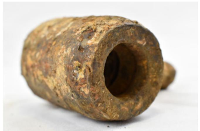
Spülkopfes konnte das nötige Wasser an das Bohrgestänge geführt werden.
